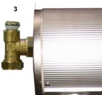
Bei der Montage, wie gezeigt, gegenhalten. Das Kollektorfühlerkabel darf nach dem Einbau NICHT unter Zugspannung stehen da es durch die Zugkräfte zum Bruch des Fühlerkabels kommen kann. Mit dem Multimeter bei abgeschalteter Steuerung den Widerstand am Fühler messen, und mit dem Sollwert in Abhängigkeit zur Temperatur vergleichen, um die Funktion zu kontrollieren. Sollwerte auf Seite 17.
